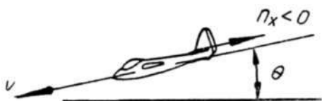
Рис. 40. Действие на планериста продольной перегрузки n_x . При отрицательной перегрузке n_x < 0 планерист съезжает с сиденья вперед. Привязные ремни, препятствуя этому, дают на него назад
