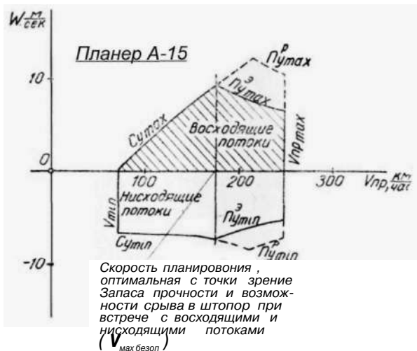
Рис. 55 а. График допустимых скоростей вертикальных потоков для планера Л-15
