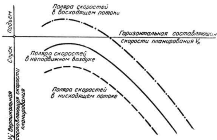
Рис. 9. Изменение полярны скоростей планера при полете в восходящем и нисходящем потоках воздуха
